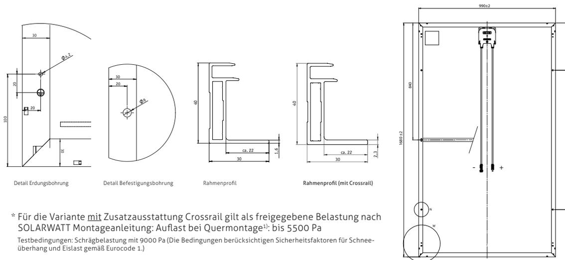
\* Für die Variante mit Zusatzausstattung Crossrail gilt als freigegebene Belastung nach SOLARWATT Montageanleitung: Auflast bei Quermontage<sup>1)</sup>: bis 5500 Pa
